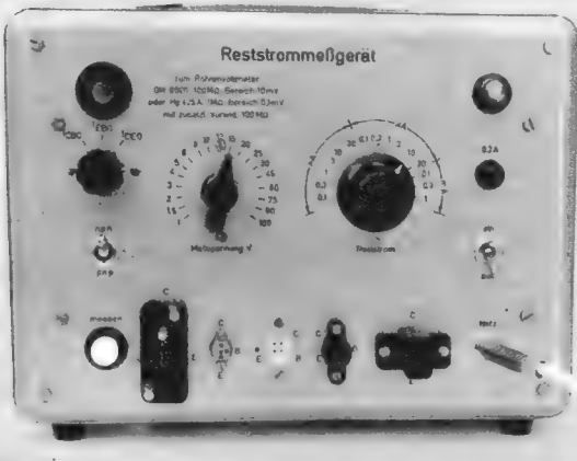
Bild 1. Frontansicht des Reststrommeßgerätes. Zur Anzeige ist ein empfindliches Gleichstrom-Voltmeter anzuschließen
