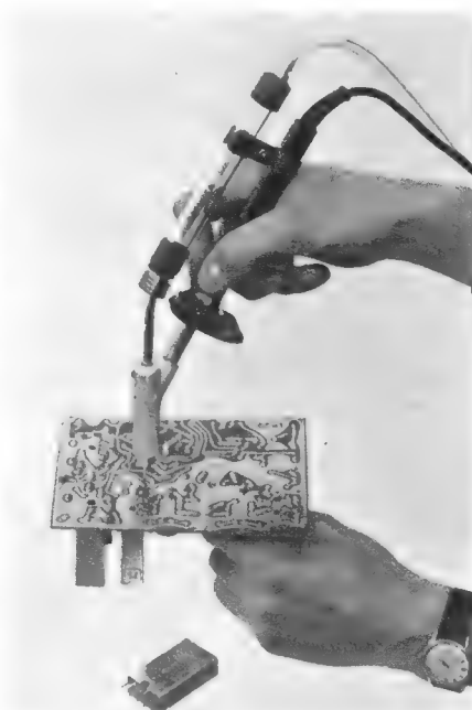
Bild 4. Vakuum-Lötkolben mit Absaugschlauch der Firma Zeva
